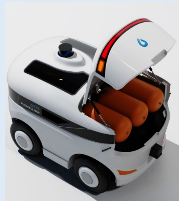
JKDesign, Самоуправляемый робот с батареями на ТЭ и запасом водорода
