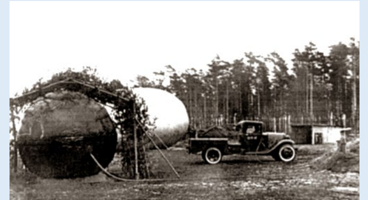
Заправка отработанным водородом из аэростатов
